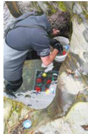
Installation des cages contenant les gammares sur le gave de Cauterets
